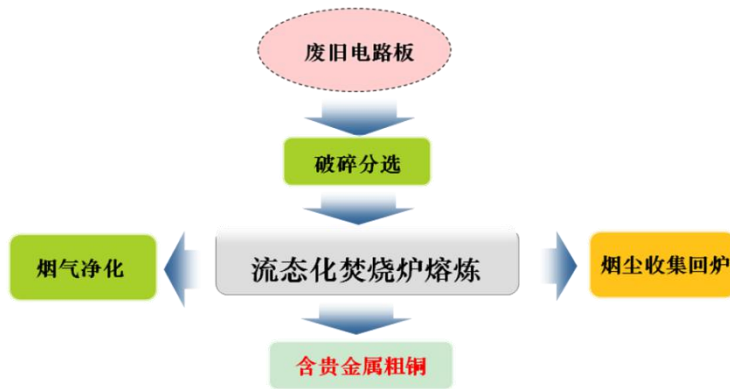
图 1 流态化焚烧炉资源化处理废旧印刷电路板技术工艺路线图
