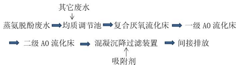
基于合成微生物技术生物膜流化床工艺流程图
